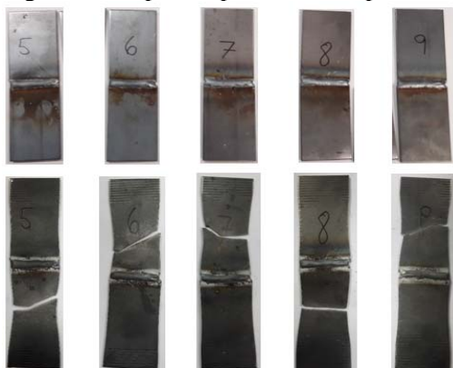
Figura 3. Corpos de prova unidos por solda MIG
