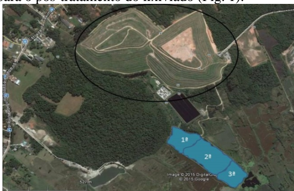
Figura 1 – Ortofoto do Aterro Sanitário da Caximba, Curitiba, PR, Brasil. Área delimitada por linha de cor preta é de disposição de resíduos; em azul, as três wetlands usadas no pós-tratamento de lixiviado (1ª a 3ª). Fonte: Kitamura e Maranhão, 2015.
