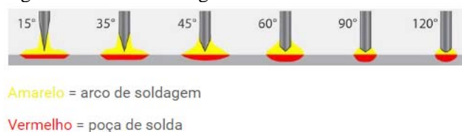
Figura 2. Influência da geometria do eletrodo
