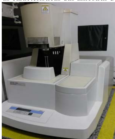
Figura 1. Equipamento DTG utilizado para determinar as características das amostras de carvão.
