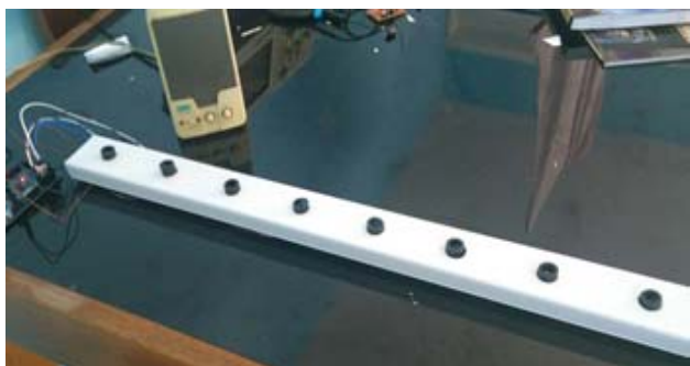
Figura 3 – Protótipo final funcional com o teclado virtual de infravermelho.
