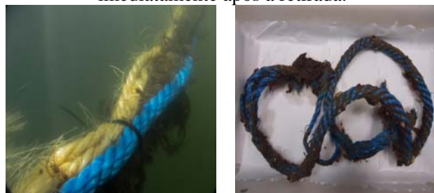
Figura 1. A – Vista parcial da corda submersa instalada na Penha. B – Vista parcial da corda imediatamente após a retirada.
