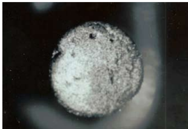
Figura 3 - Vista da seção transversal da solda, após ruptura. Técnica "sem resfriamento", com aumento de 35x
