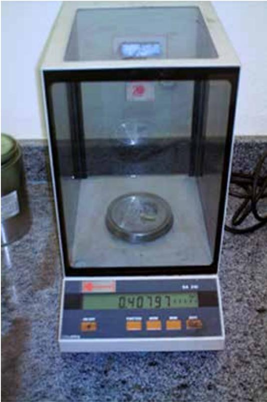
**Figura-1 - Pesagem dos dentes em balança analítica digital**
